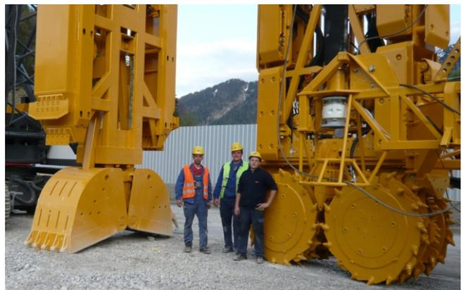
Abb. 9: Schlitzwandgreifer und Schlitzwandfräse der Firma Bauer
