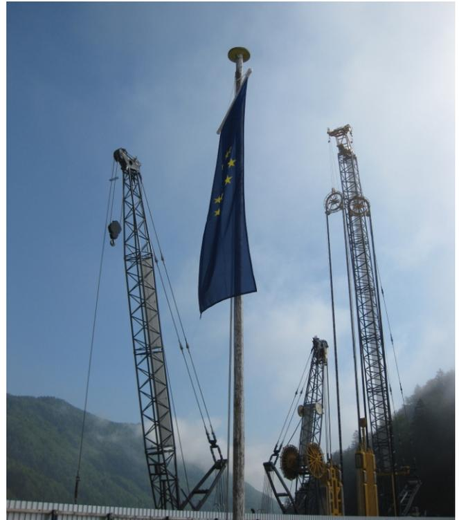
Abb. 32: EU-Flagge vor den Großgeräten zur Dichtwandherstellung
