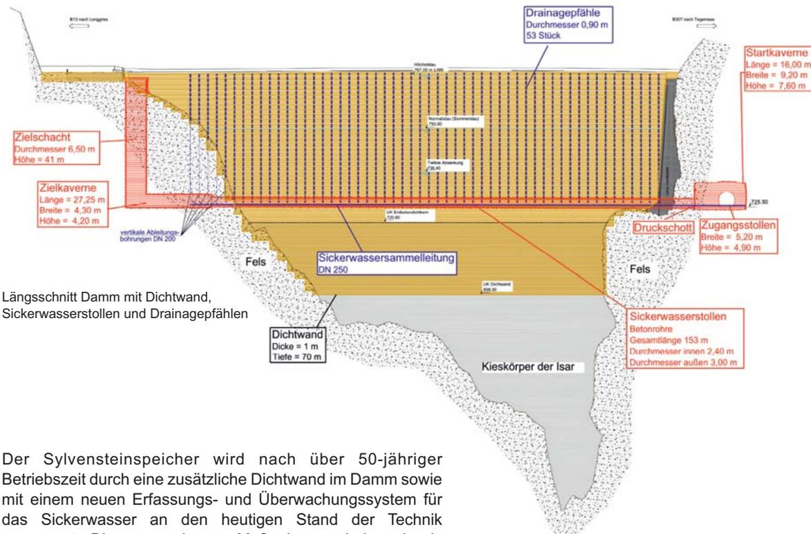
Längsschnitt Damm mit Dichtwand, Sickerwasserstollen und Drainagepfählen
