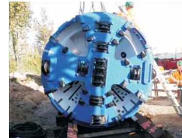
Bohrkopf einer Tunnelbohrmaschine
