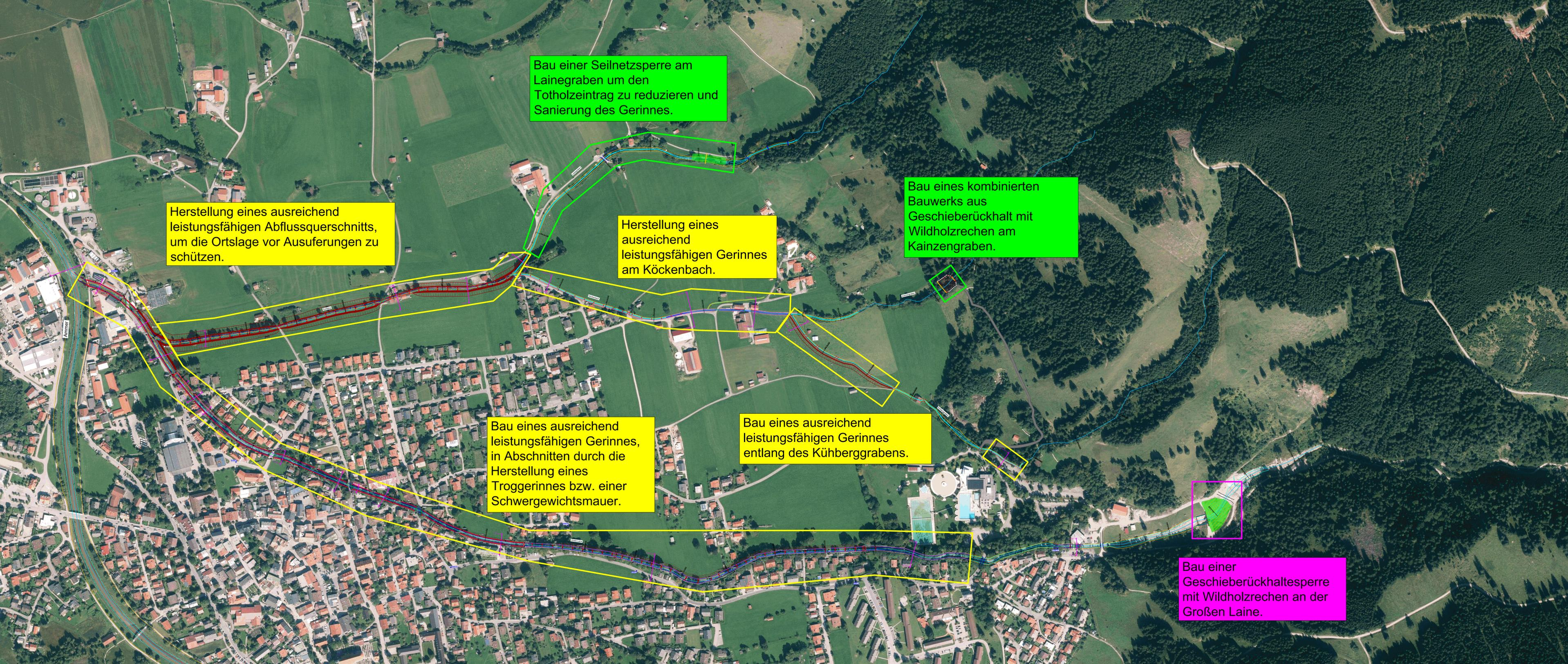
Bau einer Seilnetzsperrre am Lainegraben um den Totholzeintrag zu reduzieren und Sanierung des Gerinnes.
