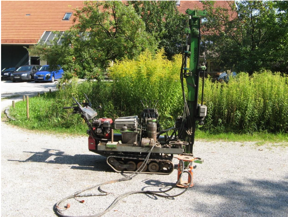
Kleinbohrgerät mit hydraulischem Zugaggregat (Beispiel)
