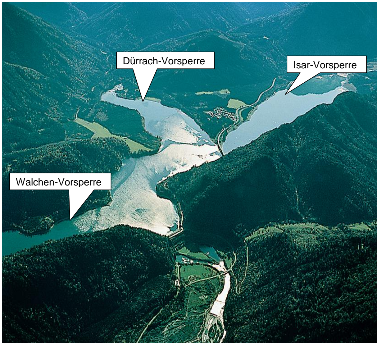
Abbildung 4: Der Sylvensteinspeicher wurde als Hochwasserschutzmaßnahme gebaut und wird von der Isar, der Dürrach und der Walchen gespeist ( http://www.alpreserv.eu/Dateien/PilotActions/Sylvenstein/Sylvenstein_de.htm [16.02.2011])
