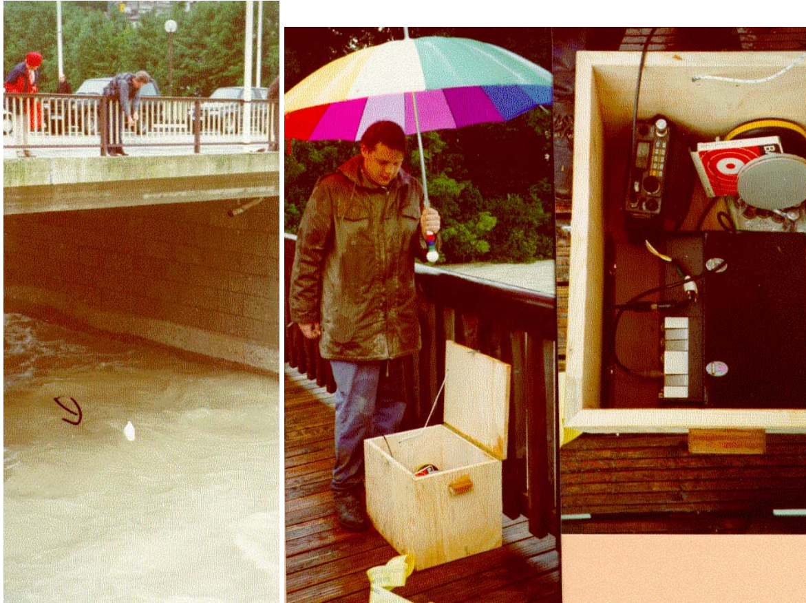
Abbildung 11: Das Einbringen der Geschiebesender in den Stromstrich und die alte feste Meßstation
