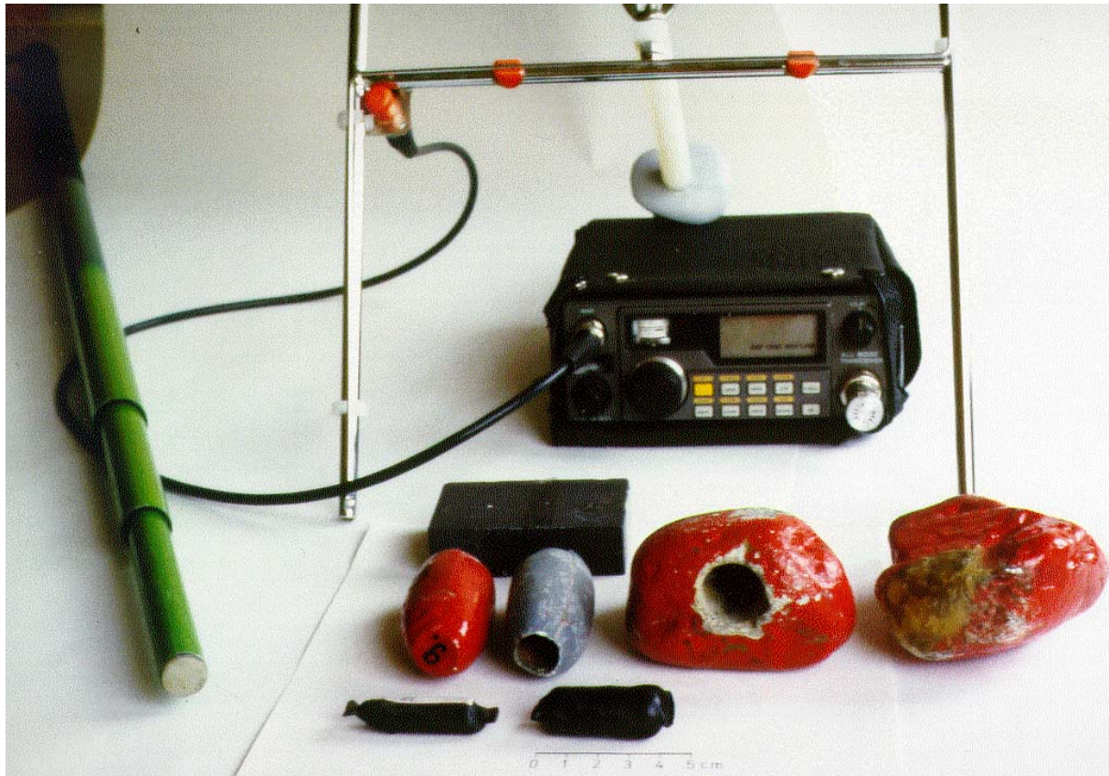
Abbildung 1: Sender, Geschiebekörner, Empfänger und Antennen zur Radiotelemetrie
