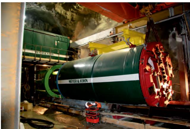
Montage der Tunnelbohrmaschine (TBM) auf der Schildwiege, dahinter Presseneinrichtung mit 6 Hydraulikzylindern für 2.500 t Schubkraft, darüber Steuerstand für den Vortrieb
