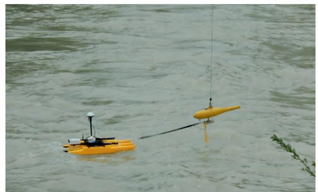
Abflussmessung am Lech bei Lechbruck mit einem Trimaran RiverSurveyor-System
