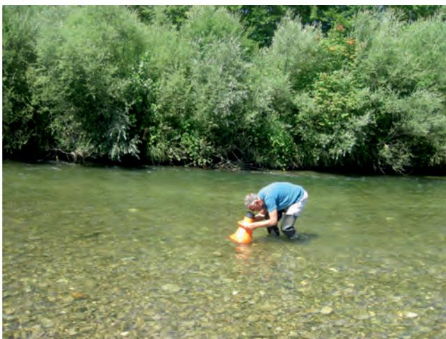
Überprüfung des Gewässergrundes mit einem Sichtkasten
